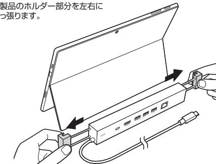
②Surfaceのスタンド部分を挟み込むようにして取付けます。
